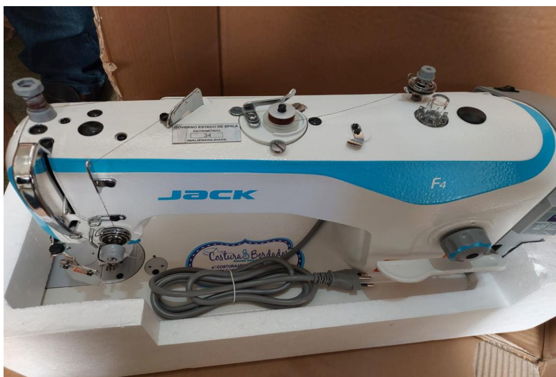
Figura 34: Máquina de Costura Reta Industrial F4 Jack
